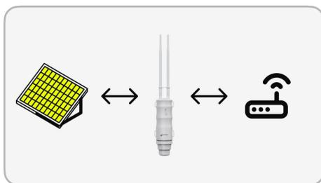
Si tu caja está a **más de 20 m** o la señal Wi-Fi es insuficiente, añade el **repetidor Wi-Fi** disponible como accesorio<sup>1</sup>.
