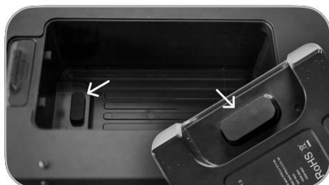
**2** – Coloca la batería en la PLAY Box situada en la parte trasera de la estación.
